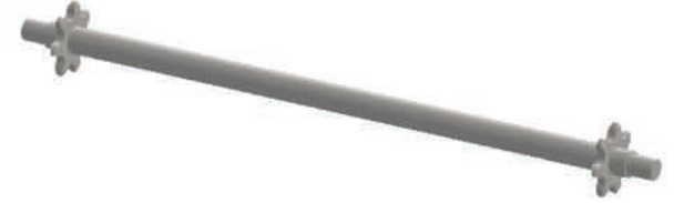
Üst Konveyör Avare Dişli Mili Upper Conveyor Idler Gear Shaft
