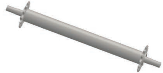
Üst Konveyör Avare Dişli Mili Upper Conveyor Idler Gear Shaft
